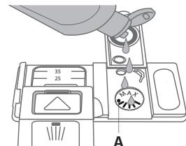
1. Stlačením a zatažením páčky na víku zásobníku **B** otevřete.
