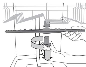
Horní ostřikovací rameno sejměte pootočením plastového upevňovacího kroužku proti směru hodinových ručiček. Horní rameno lze otočit tak, že jeho strana s větším množstvím otvorů směřuje vzhůru..
