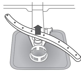
Spodní ostřikovací rameno lze vyjmout zatažením směrem nahoru.
